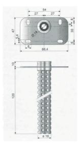
**AX-TC-VT-250** Fixing Flange 250mm
